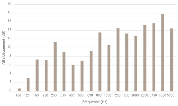
Courbe extraite du rapport d'essai du CTTM nº A170240\_01\_A (norme ISO 10053)
