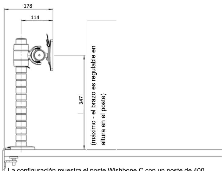
La configuración muestra el poste Wishbone C con un poste de 400 mm y una abrazadera universal para escritorio.
