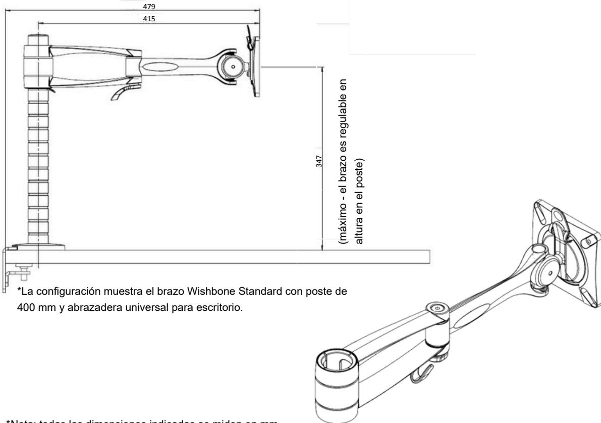
\*La configuración muestra el brazo Wishbone Standard con poste de 400 mm y abrazadera universal para escritorio.
