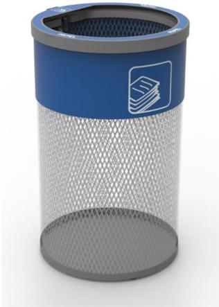
Papelera de gran capacidad, fabricada en malla de acero, con aro superior portabolsas fabricado en pletina de acero de 3 mm., que bascula sobre un eje de giro de acero de 3 mm. soldado al cuerpo, así como un soporte de acero de 3 mm. soldado a 180° del eje. Cabezal batiente fabricado en acero estampado de 1 mm de espesor rotulado con vinilo de alta adherencia según tipo de residuo determinado por la propiedad. Dispone de una bisagra de retención para evitar el cierre accidental del cabezal.
