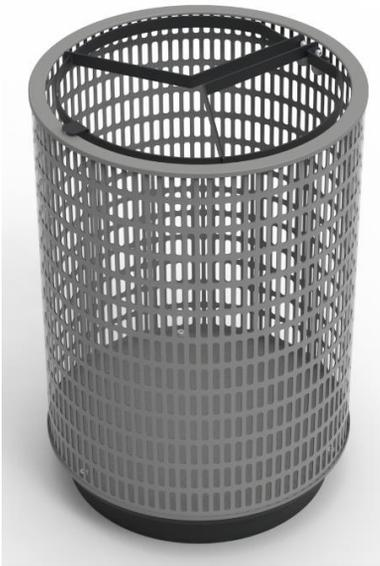
Papelera de un residuo de gran capacidad, fabricada en chapa perforada, con aro superior portabolsas fabricado en pletina de acero de 3 mm., que bascula sobre un eje de giro de acero de 3 mm. soldado al cuerpo, así como un soporte de acero de 3 mm. soldado a 180° del eje.
